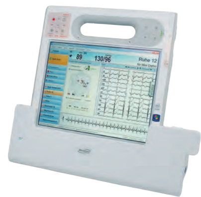
Docking-Station mit USB- und LAN-Anschlüssen, sowie Akku-Ladeeinrichtung
