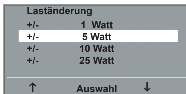
AUSWAHL DES SCHRITTWEITE FÜR MANUELLE LASTÄNDERUNG
