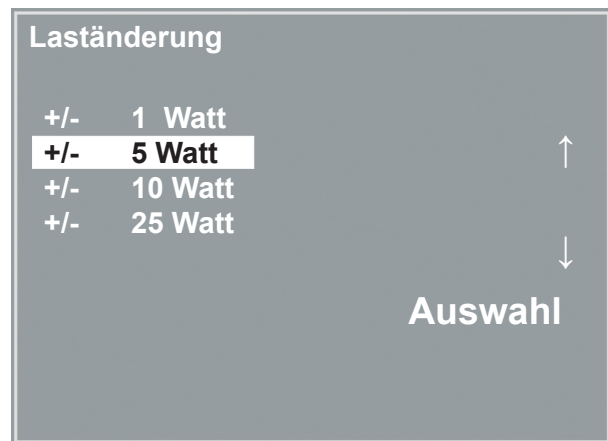
AUSWAHL DES SCHRITTWEITE FÜR MANUELLE LASTÄNDERUNG
